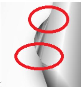
« », в котором присутствует уширение. Данное уширение начинается и заканчивается без каких-либо стыков, углов или других резких переходов, а его толщина имеет максимальную величину не доходя до границ технологического выреза. Также следует отметить, что визуализация светлых и
