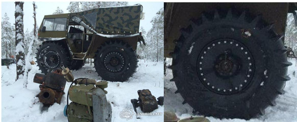
характеризуются, следующими общими признаками отображенными на изображениях изделий: выполнением в форме кольца; наличием протектора на внешней поверхности; выполнением протектора включающим одно ребро, состоящее из горизонтально расположенных грунтозацепов; выполнением грунтозацепов в виде выступов, постепенно расширяющихся к внешней поверхности шины; выполнением грунтозацепов заходящими на боковые поверхности шины с образованием на ней трапециевидных элементов с узким верхним основанием.
