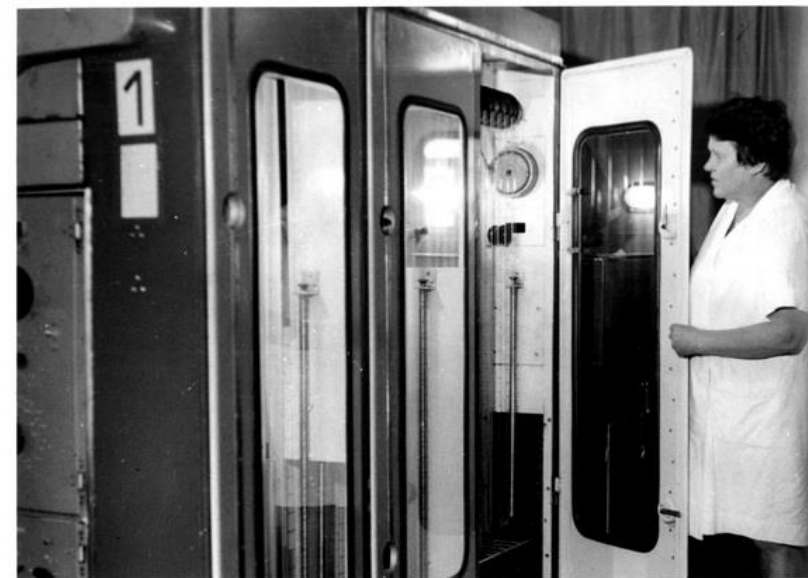
Высокоскоростная проявочная машина „40 П-3“ (СССР) для проявления рольных микрофильмов
